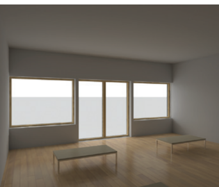
Igralnica z nadstreškom, analiza faktorja dnevne svetlobe, 21. marec, 12:00, oblačno nebo.
